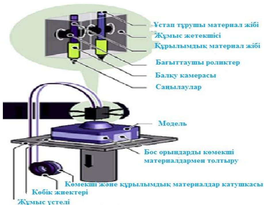
1.5-сурет – FDM қабатталған термиялық өңдеу баспа технологиясы
